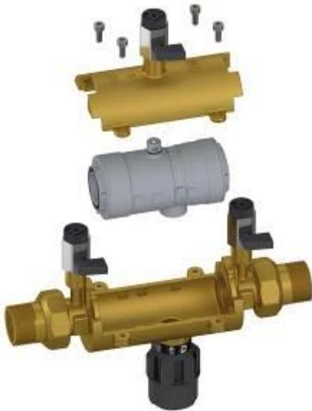
Der neue Systemtrenner BA 6610 in-line LF vereinfacht die jährliche Wartung deutlich. Einfach die Komplettpatrone entnehmen und durch eine neue, normkonform geprüfte Komplettpatrone ersetzen – schon ist der Systemtrenner wieder einsatzbereit.
